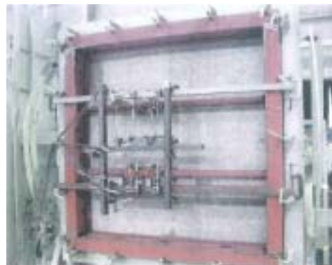
写真 耐風圧試験実施状況
