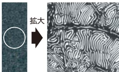
塗装焼付け時に、塗膜の上層側と下層側で硬化速度に差を持たせ、塗膜表面をちぢませた独特な意匠性
