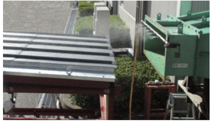
送風散水試験状況
